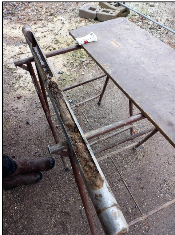
Abbildung 12: Aus einer Bohrung entnommene zwei-Meter-Schappe mit Bohrgut.
