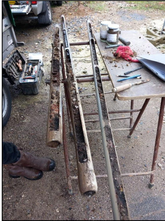
Abbildung 13: Weitere mit Bohrgut gefüllte Schappen. Hieraus erfolgte die Probenentnahme je Horizont bzw. je laufendem Meter
