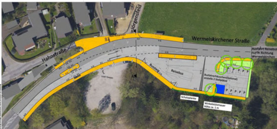
Möglicher Ausbau der Haltestelle Jörgensfeld als Endstelle (Bildquelle: Büro Stadtverkehr Hilden, Planausschnitt)
